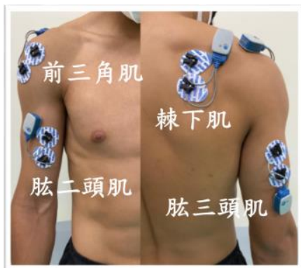
圖 2 EMG 肌肉信號感測器(Sensor)於肱二頭肌、肱三頭肌外側頭、前三角肌、棘下肌等四個肌群
